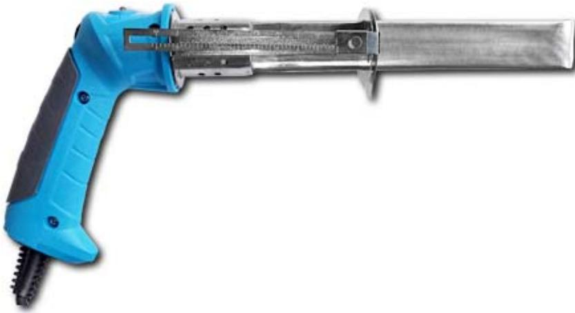
Coltello a lama calda dotato di potenziometro per variare la temperatura della lama in base al polimero da lavorare. Possibilità di modificare la lunghezza della lama a contatto del materiale da lavorare tramite supporto graduato. Applicazioni tipiche : taglio e sagomatura di lastre di polistirolo per imballaggi, pulizia puntali ugelli da residui d'iniezione, rimozione di residui termoplastici su macchinari per iniezione, taglio di film termoplastici.
